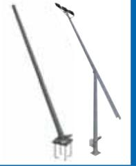
Los **apoyos troncopiramidales** se pueden suministrar **con un sistema de abatimiento a media altura**. Este tipo de soporte **se compone de un tramo fijo y de un tramo pivotante que gira alrededor de un eje**. El tramo pivotante, una vez que se encuentra en posición vertical, dispone de un sistema de enclavamiento para fijarlo en esta posición. El correcto funcionamiento de este sistema precisa del conocimiento preciso de la carga en cabeza del apoyo.
