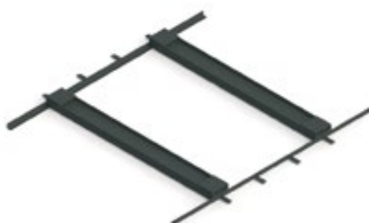
Carriles apoyo trafo
