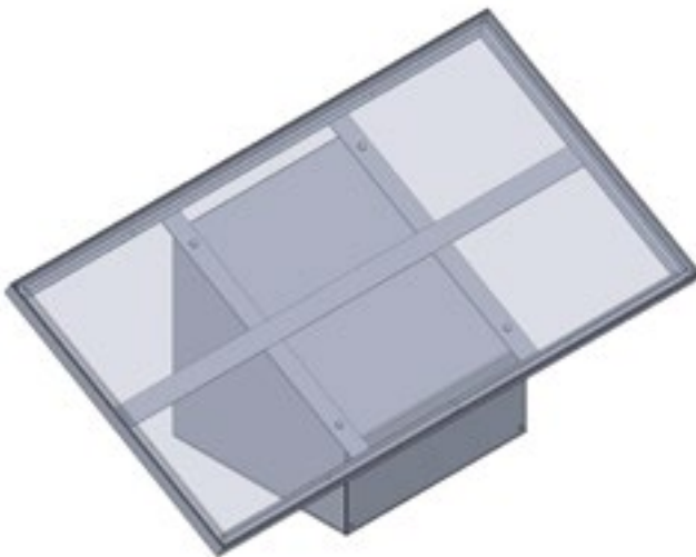
Cajón portaequipos con soporte para panel solar, para instalación sobre columna.
